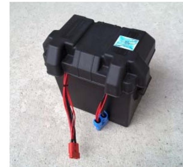
von mir gefertigte Akkus mit je 24V und einer Kapazität von 100 Ah. Das Gesamtgewicht beträgt nur 40 kg.
