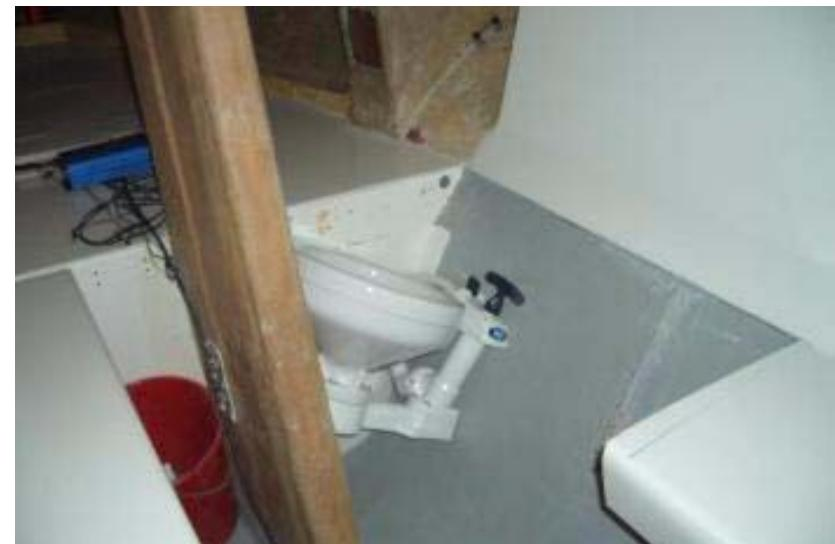
dem somit entstandenen Raum kam die Seetoilette und ein Waschbecken mit einem Pumphahn für Seewasser und einem Hahn für die Druckwasseranlage.
